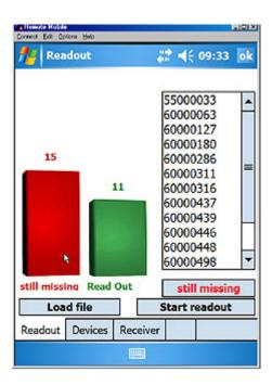
La información de la emisión de cada radiador se transmite por radiofrecuencia de manera mensual o anual (según se desee) a un sistema de recogida de datos que permite a la empresa encargada de gestionar las mediciones de recoger de forma sencilla y rápida los valores de todos los Repartidores. Los datos recogidos por el sistema se pueden exportar de manera sencilla a una hoja de cálculo para su posterior incorporación al sistema de facturación.
